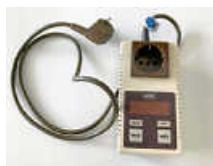
Strommessgerät. Foto: Stadt Filderstadt
