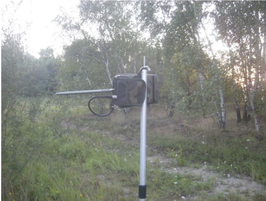
Abbildung 7: Automatisches Aufzeichnungsgerät (batcorder der Fa. ecoobs)
