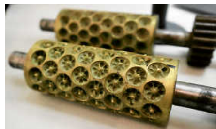
Wellholz mit vorgefertigten Formen.
