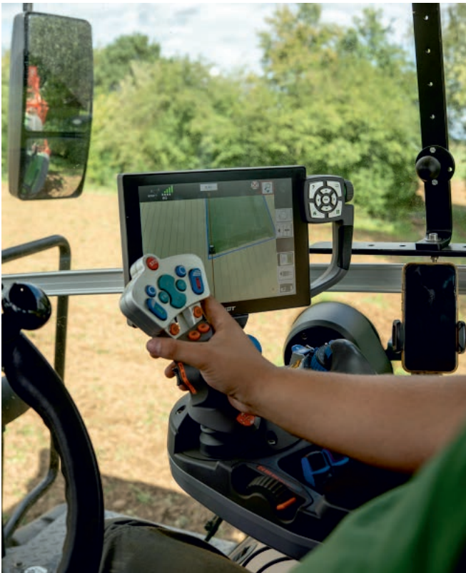
Traktorsteuerung mit GPS-Bedienkonsole, Foto: Felix Kerlein
