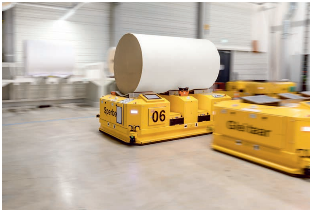
Auch die interne Mobilität wurde konsequent mit Ökostrom elektrifiziert. Hier zwei Fahrzeuge des fahrerlosen Transportsystems im neuen Werk 2 bei der Arbeit. Foto: HERMA GmbH
